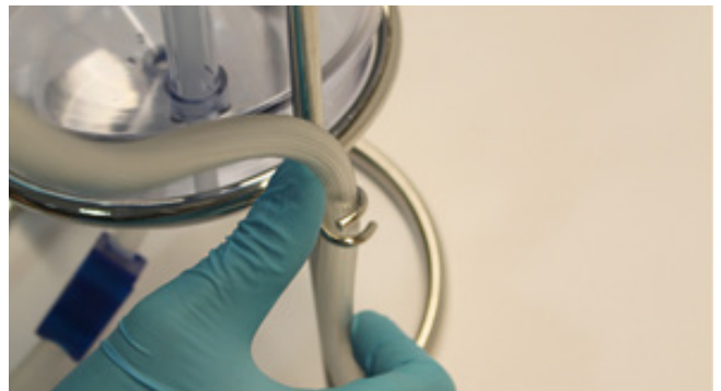
Figur 6. Væskeuttømmingsslangen festes så i "Pigtale"-kroken for å forhindre at Y-konnektoren klapper sammen.
